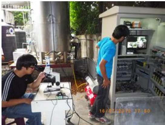
照片5，現場作水樣及污泥樣顯微觀察 與遠端數位影像傳輸
