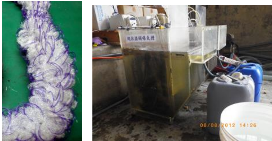
圖 5.6 繩狀濾材填充率 40%，效果良好
